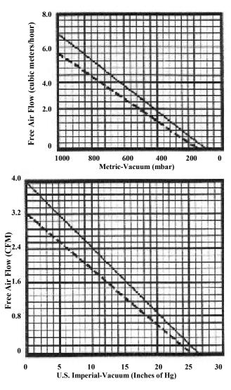
CONSTANT AIR FLOW REGULATOR CURVE TYPICAL PUMP OPERATING FLOW RANGE
